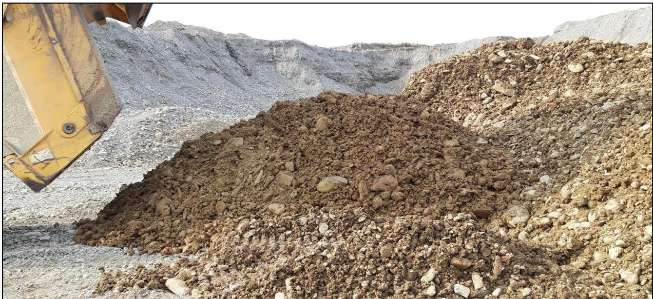
*Figura 1: Sondaggio investigativo condotto con mezzo escavatore in cava Fornace 1 a quote comprese fra -15 m p.c. e -20 m p.c.: Giacimento caratterizzato da un'eccessiva matrice limo-argillosa giallo-ocra.*
