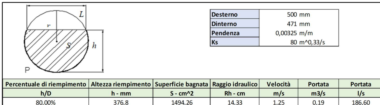
Figura 12: Verifica diametro collettore principale "Tratto A".
