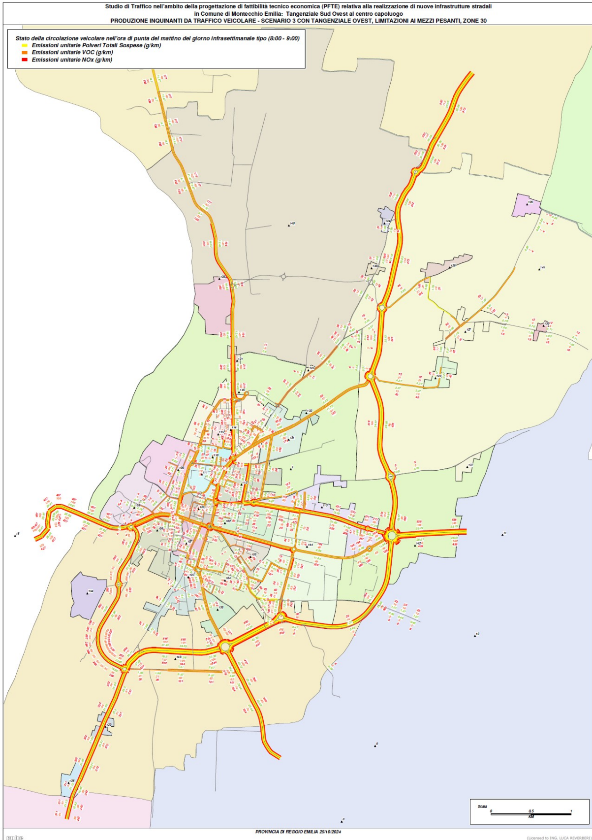
Figura 45: Produzione inquinanti da traffico veicolare nell'ora di punta 7:30 – 8:30 SCENARIO 3 CON TANGENZIALE OVEST, LIMITAZIONI AI MEZZI PESANTI, ZONE 30
