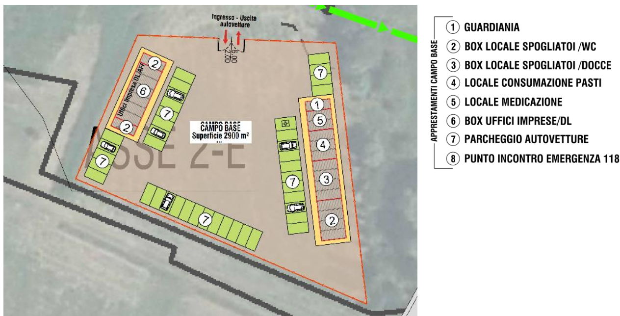
Figura 3.4 –Layout Cantiere Base
