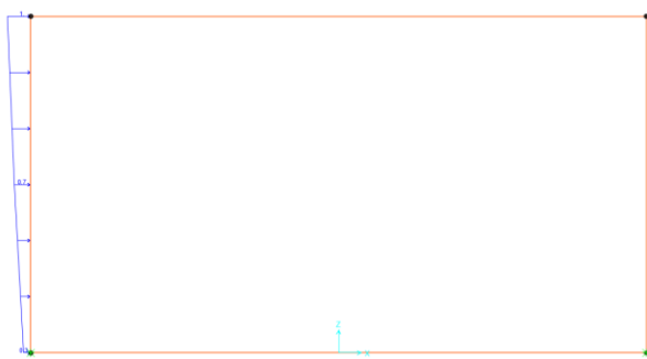
Figura 9-23 Sovraccarico da traffico su rilevato: 0.426 \times 91 \text{ kN/m/m} (schema 2) = 39 kN/m/m
