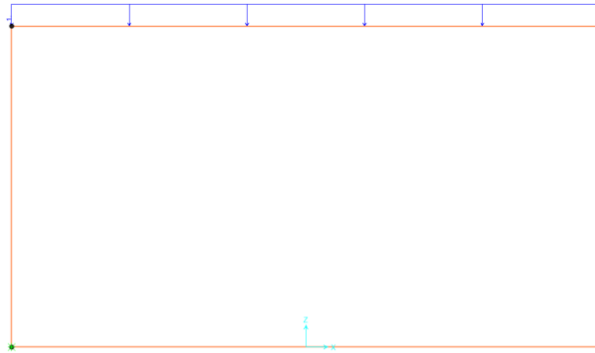
Figura 9-21: Peso permanente portato della pavimentazione: 9.6 kN/m/m (pacchetto stradale).
