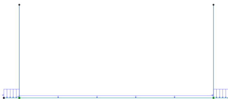
Figura 9-4: Peso permanente portato del terreno di ricoprimenti: sotto la pavimentazione stradale 15.2 kN/m/m, sull'esterno della ciabatta di fondazione 60.8 kN/m/m.
