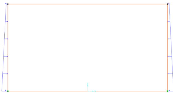
(a) Spinta del terreno in condizioni statiche: - Spinta statica: K_0=0.426 ; \gamma = 19 \text{ kN/m}^3
