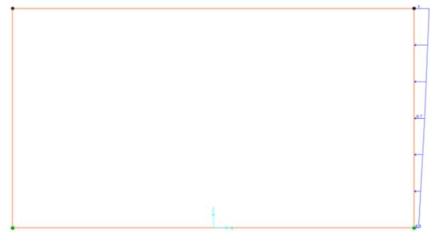
Figura 9-23 Sovraccarico da traffico su rilevato: 0.426 \times 91 \text{ kN/m/m} (schema 2) = 39 kN/m/m
