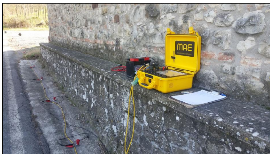
Figura 9 – Esecuzione di una prova MASW mediante sismografo MAE modello A6000SE a 24 canali.
