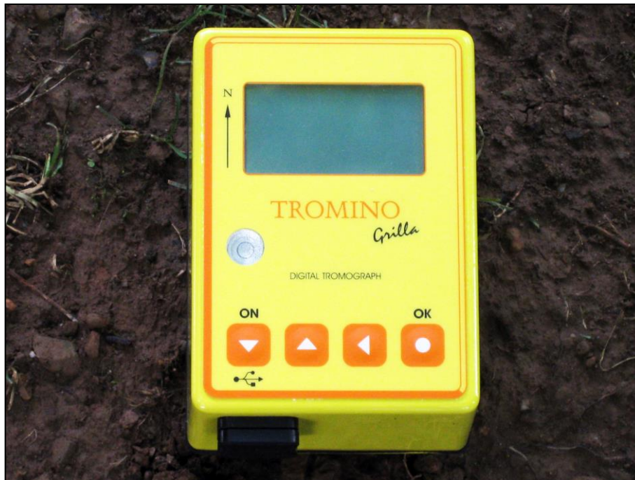
Figura 10 – Esecuzione di una registrazione del microtremore ambientale mediante TROMINO.
