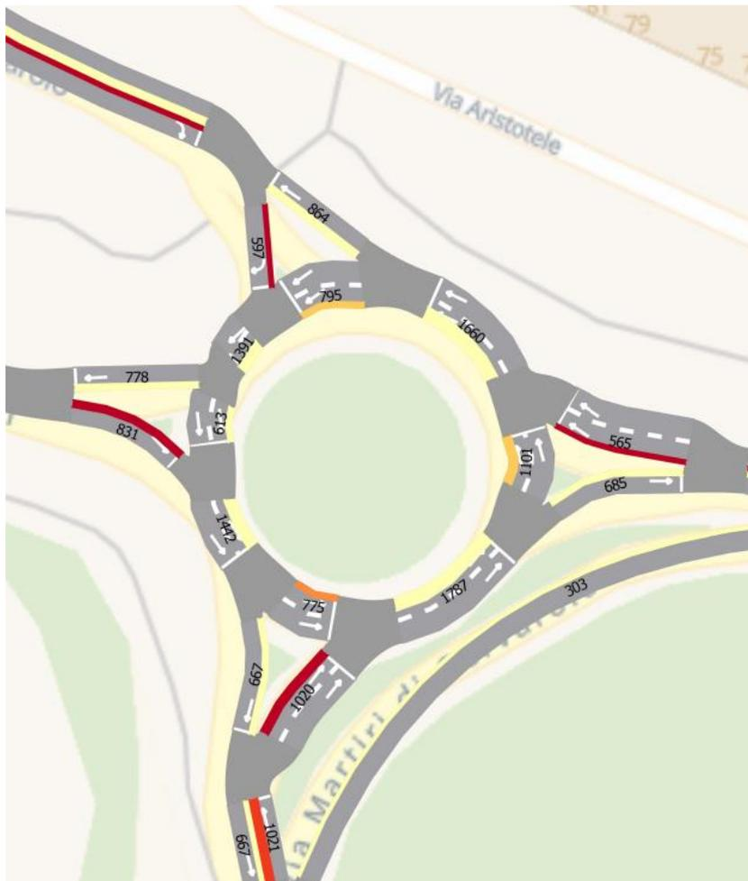
Scenario 0 – Flussogramma di dettaglio della rotatoria SP467/tangenziale
