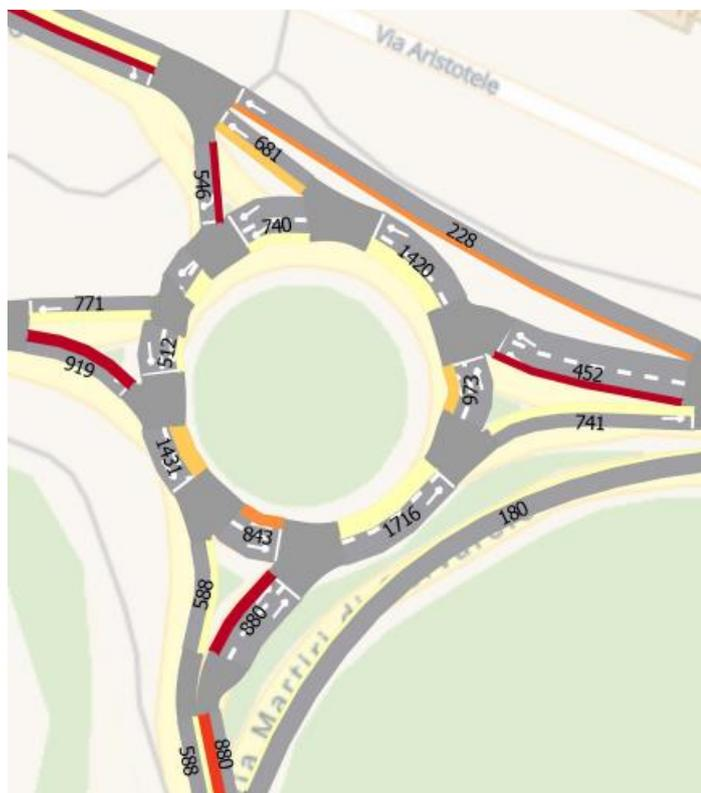
Alternativa E – Flussogramma di dettaglio della rotatoria SP467/tangenziale
