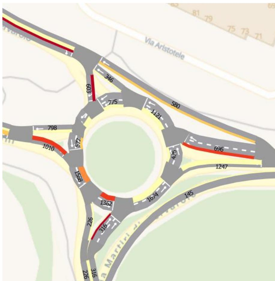
Alternativa A – Flussogramma di dettaglio della rotatoria SP467/tangenziale
