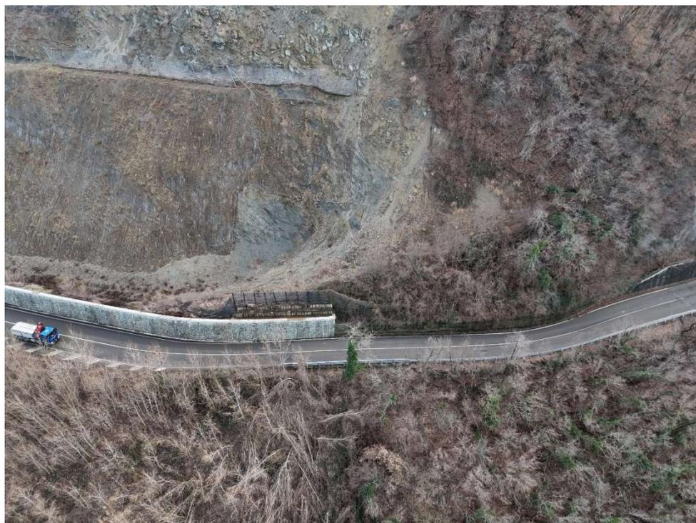
Figura 14 – Vista del settore oggetto degli interventi per mezzo drone. Notare a sinistra (Est) la presenza di interventi precedenti, in particolare la trincea artificiale a piede versante.
