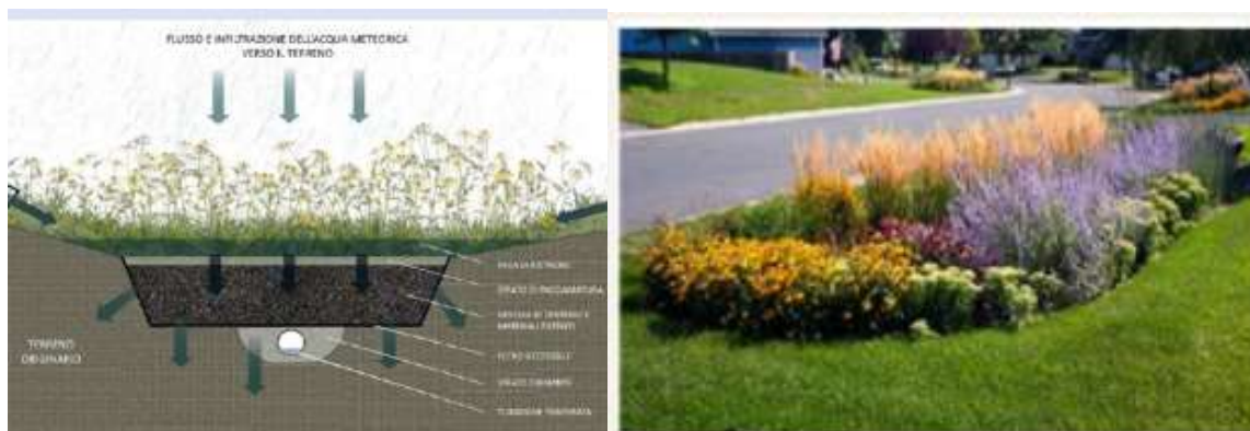
Figura 25 –Schema tipo ed esempio di Giardino della pioggia.
