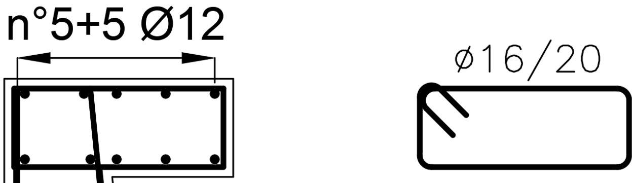
Armatura tipologica cordolo di testa
